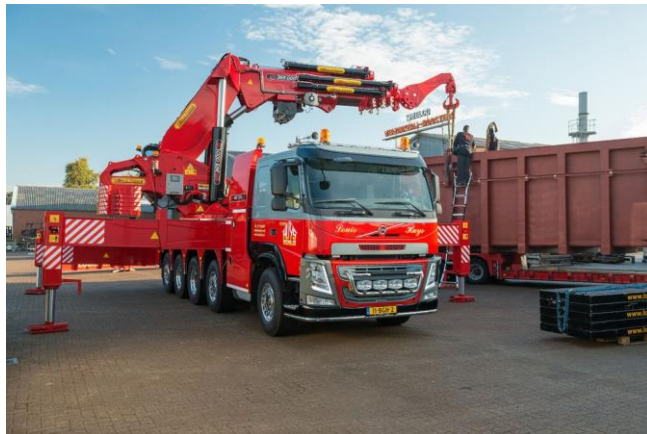
Figuur 12 Volvo FM met 365 tonmeter kraan
