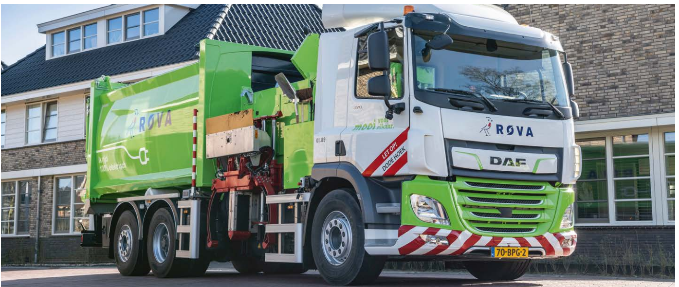
Een elektrisch aangedreven zylader van ROVA, die hiermee sinds begin 2020 op proef rijdt.
